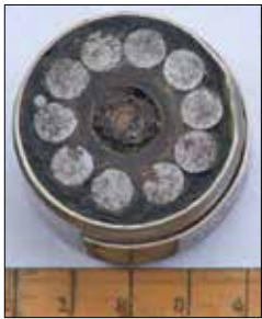
Przekrój pierwszego kabla telegraficznego kładzonego przez kablowiec s/s Stephan w 1904 r.
